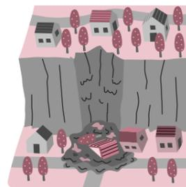
斜面の地表に近い部分が雨水の浸透などで緩み、突然崩れ落ちる現象
