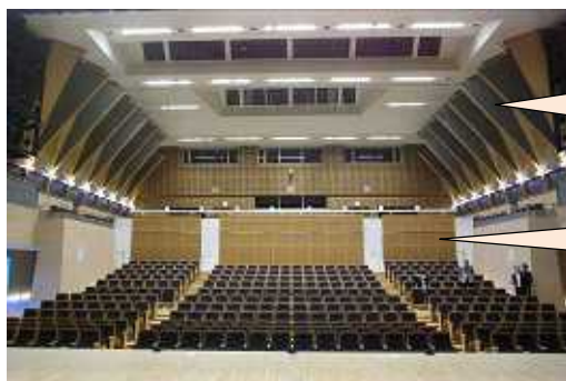
メインホール：同上 みの～れ 可動式吸音パネル及び仕切りパネルを出した状態（322席）
