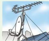
若屋顶有出现裂缝，偏移或脱落情况，请务必进行加固。请确认天线的晃动情况。
