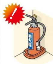
灭火器的设置请避开阳光直射和湿气多的地方。
