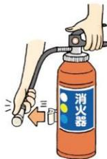
3 Si aprieta la palanca con fuerza saldrá el chorro del extinguidor. Apunte a la base de la llama, no sobre el humo o las llamas.
