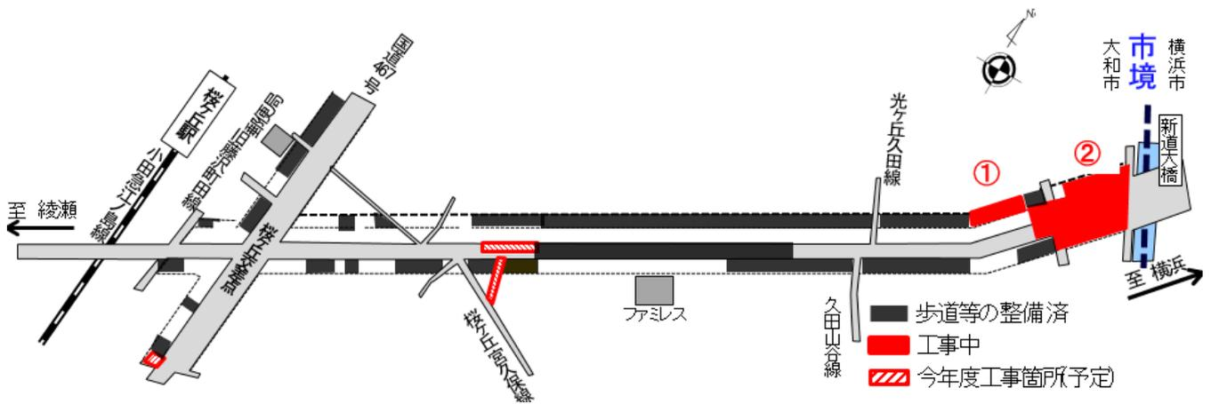
黒色で示す箇所については、歩道等の工事が完了しております。赤色で示した部分は①擁壁や歩道の整備、②歩道の工事および車道の打ち換え工事等を行っています。工事完了後は新道大橋から光ヶ丘久田線までの北側歩道が拡幅される予定となっております。
