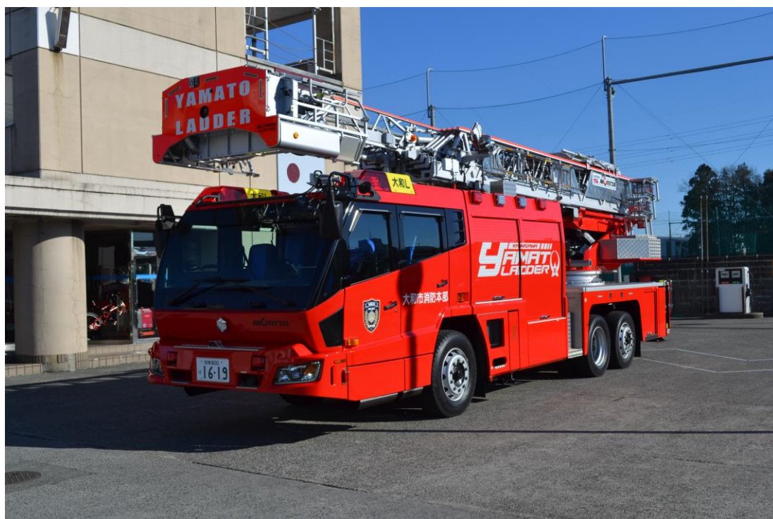
【令和3年度の更新車両 30m級先端屈折式梯子付消防自動車】
