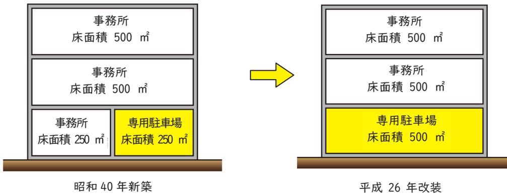
水噴霧消火設備の設置基準面積に関する現行の政令の規定の施行（基準時：昭和50年1月1日）の際、現に存する防火対象物で、法第17条の2の5第2項の規定に該当しないため、水噴霧消火設備等の設置を要しない。
