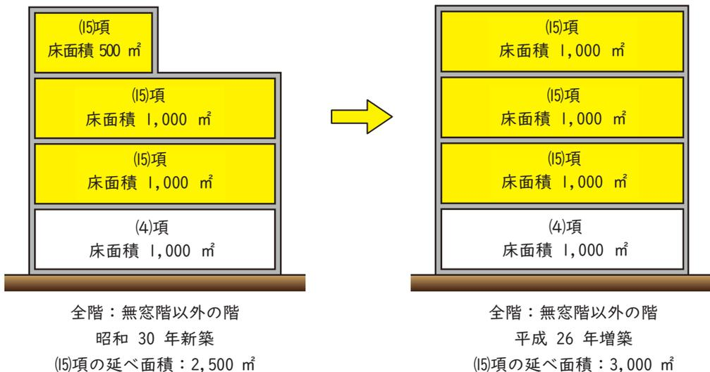
政令第11条第1項第3号の規定の施行（基準時：昭和 36 年 4 月 1 日）の際、現に存する防火対象物で、法第17条の2の5第2項第2号に定める増築（床面積 1,000 m²以上又は延べ面積の2分の1以上）に該当しないが、当該防火対象物が特定防火対象物で、法第17条の2の5第2項第4号に該当するため、(15)項に掲げる部分に屋内消火栓設備の設置を要する。
