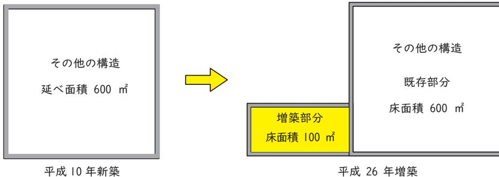
屋内消火栓設備の設置基準面積に関する現行の政令の規定の施行（基準時：昭和 36 年 4 月 1 日）後に新築されたものであり、増築によって当該規定に適合しなくなるものであるから、法第 17 条第 1 項の規定により設置義務が生じる。
