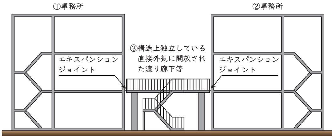
3棟の防火対象物として、消防用設備等を設置する。
