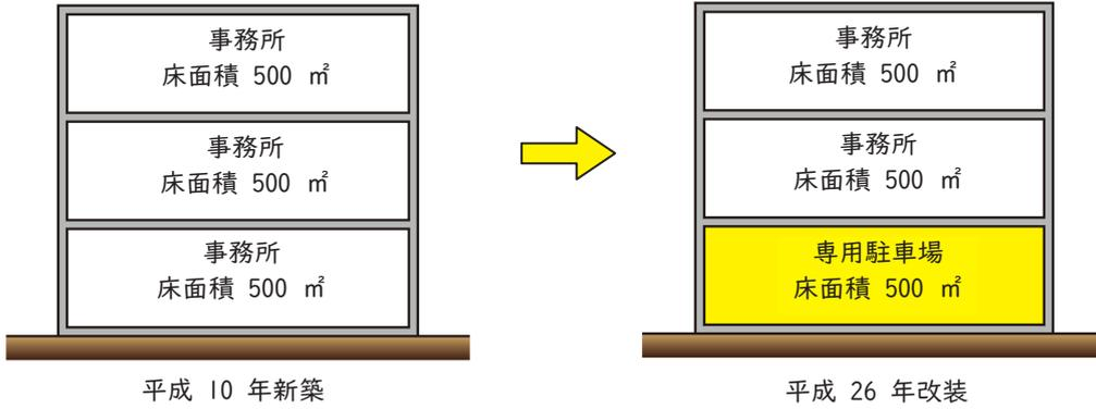
主たる用途（事務所）に機能的に従属するものであり、当該防火対象物の用途自体は変更しないことから、法第17条の3第1項に規定する用途が変更されたものに含まれず、同条の規定は適用されず、法第17条第1項の規定により水噴霧消火設備等の設置義務が生じる。
