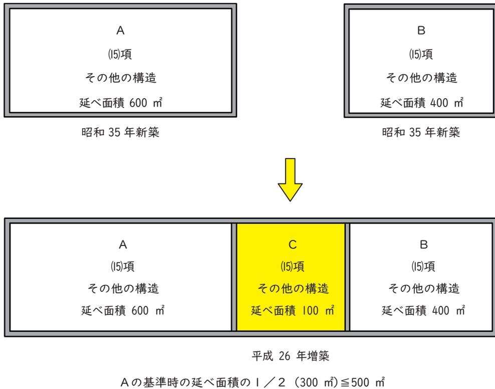
屋内消火栓設備の設置基準面積に関する現行の政令の規定の施行（基準時：昭和 36 年 4 月 1 日）の際、現に存する防火対象物A及びBであるが、Aにとっての増築はB+C（500㎡）であり、法第17条の2の5第2項第2号に定める増築（基準時の延べ面積の2分の1以上）に該当するため、屋内消火栓設備の設置を要する。
