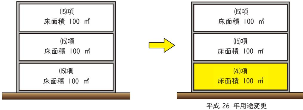
政令第21条第1項第3号イの規定により、防火対象物全体に自動火災報知設備の設置を要する。
