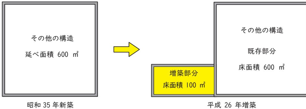
屋内消火栓設備の設置基準面積に関する現行の政令の規定の施行（基準時：昭和 36 年 4 月 1 日）の際、現に存する防火対象物で、法第 17 条の 2 の 5 第 2 項第 2 号に定める増築（基準時以後における床面積 1,000 m²以上又は基準時の延べ面積の 2 分の 1 以上）に該当しない場合は、屋内消火栓設備の設置は要しない。
