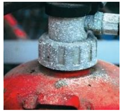
<あばた状の腐食>
